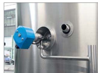
Nettoyeur de paroi
