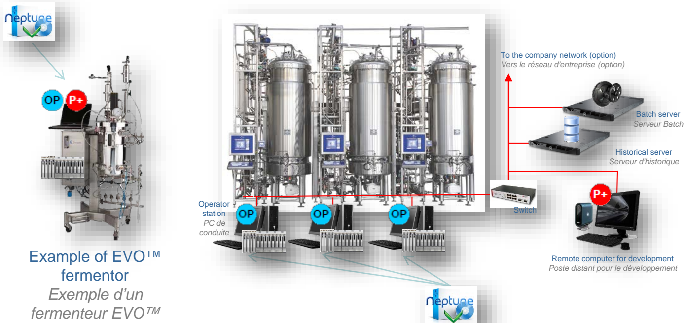
Example of private Client/Server architecture Exemple d'une architecture Client / Serveur privée
