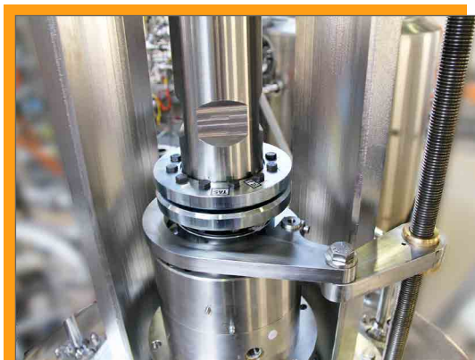
Cric pour extraction latérale du boîtier
