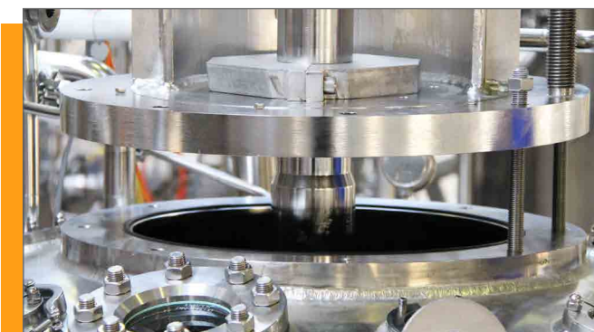
Pince de maintien de l'arbre d'agitation
