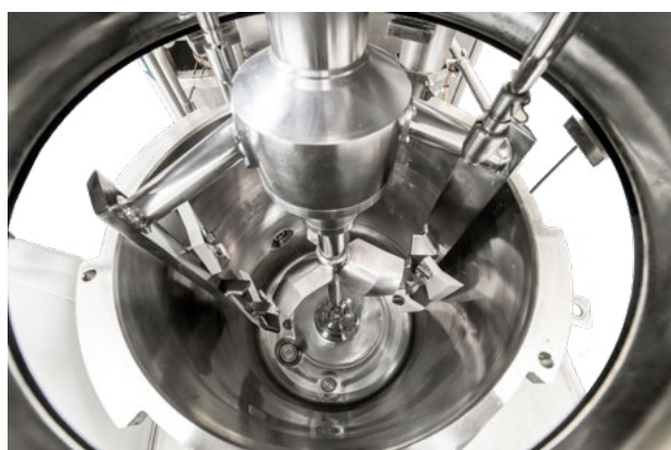
Emulseur TR + en fond de cuve avec un système coaxial pendulaire
