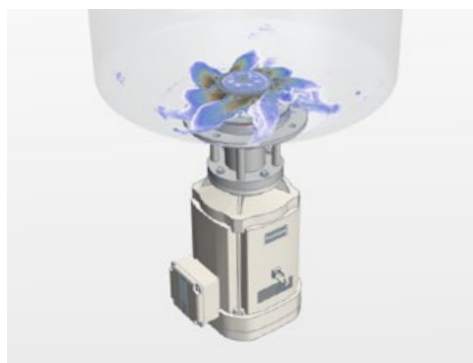
Simulation 3D-CFD du taux de cisaillement en cuve
